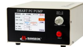
로터와 연결되어 있는 모터를 제어하는 컨트롤러로 최대 120rpm까지의 모터 스피드를 Shot과 Suck Back 양방향으로 제어가 가능합니다. Real & Time 두 가지 방법으로 ON/OFF 제어와 시간 설정 제어 모두 사용이 가능합니다.
