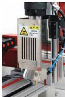
330ml cartridge 타입의 고점도 핫멜트 액을 그대로 장착 일정온도 (~160 C)로 가열하여 토출하는 로봇시스템입니다.
