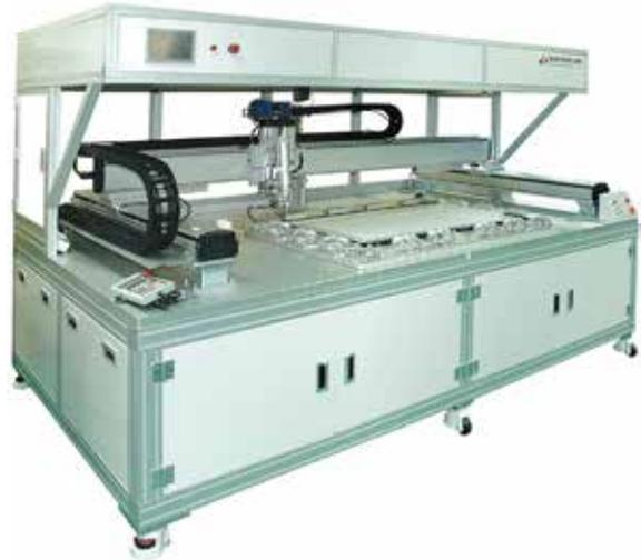
BACK LIGHT UNIT 생산 공정 중 SUPPORT MAIN과 GLASS와의 조립 시 SUPPORT MAIN에 부착하는 PAD를 실리콘으로 대체한 장비입니다.
