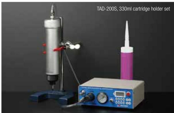
102 System과 같은 원리로 330ml 카트리지형의 재료를 직접 330ml 카트리지 Holder에 넣어 토출하는 형태입니다. 330ml 카트리지를 잡아주는 Holder와 Screw adapter, Needle adapter 등으로 구성됩니다.
