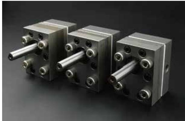
흡입구에서 Gear 맞물림이 풀어질 때 회전 Gear의 흡에 액체가 채워진다. 이때 Gear casing 및 Plate에 의해 생긴 공간에 액체가 채워지면 Casing 내부 원주를 따라 토출쪽으로 이동한다. 토출구에서 액체는 Gear 맞물림에 의해 흘러간다.
