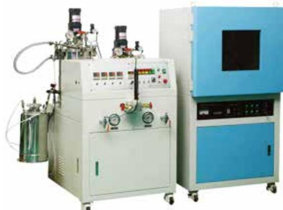
TAD-233 2액형 장비에 진공 챔버 내에서 Robot에 의한 진공 주입을 적용한 System
