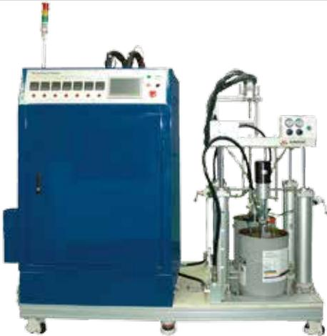
TAD-233 2액형 장비에 Can pump를 적용하여 고비중 액 사용시 적합한 시스템, 결정질 태양전지 모듈 잉곳 에폭시 글루잉용 2액형 자동 토출 장치
