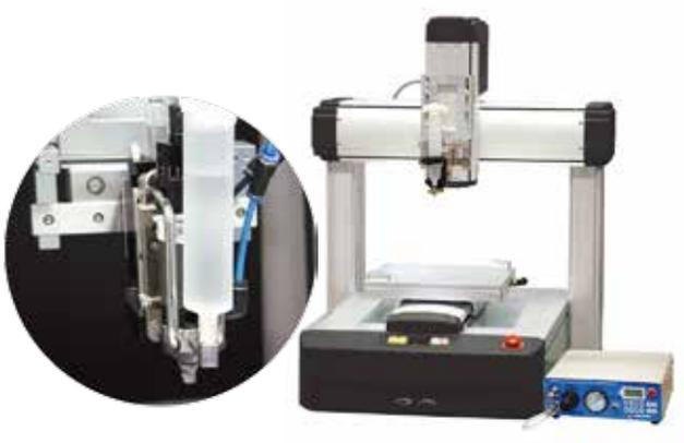
도포 로봇의 동작 도포 속도는 응용 프로그램에 따라 다르지만 10mm/sec ~ 500mm/sec 범위에서 통과 점 제어가 가능한 로봇이면 사용할 수 있습니다. 나노 스프레이 프로그램은 통과 점 제어가 가능한 CP 동작으로 코팅을 하는 것이 기본으로 스프레이 건 ON, OFF 타이밍과 같이 동작설정을 해야 하지만 응용 프로그램에 따라 도포 건 고정으로 피도물 동작의 연속도포 예도 있습니다.
