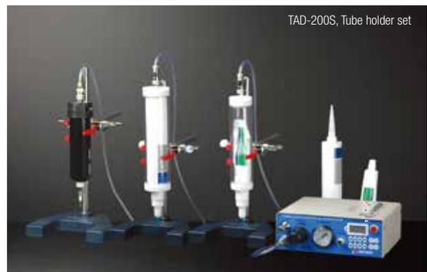
102 System과 같은 원리로 Tube형의 재료를 직접 Tube holder에 넣어 토출하는 형태입니다. Tube를 잡아주는 Holder와 카트리지, Tube holder adapter, Needle adapter 등으로 구성됩니다.
